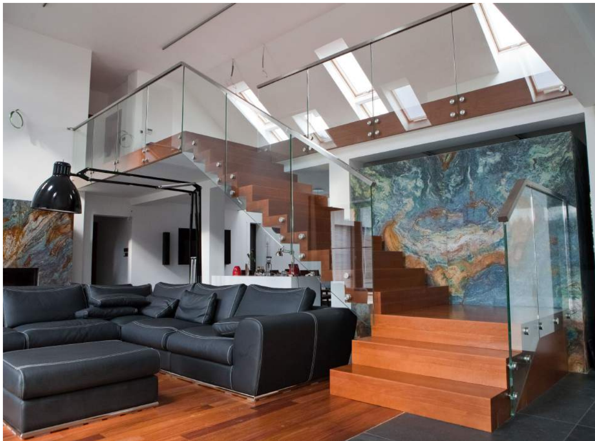
L-formad trappa med räcke Glas 13 mm. Steg i betsad och lackad bok. Handledare i borstat rostfritt stål.
